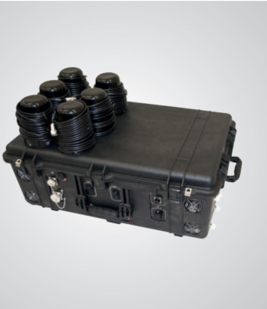
Изделие предназначено для противодействия радиоуправляемым взрывным устройствам РВУ посредством генерируемого сигнала во всем диапазоне рабочих частот, предназначен для защиты от РВУ при передвижении на транспортном средстве и в стационарном положении.
