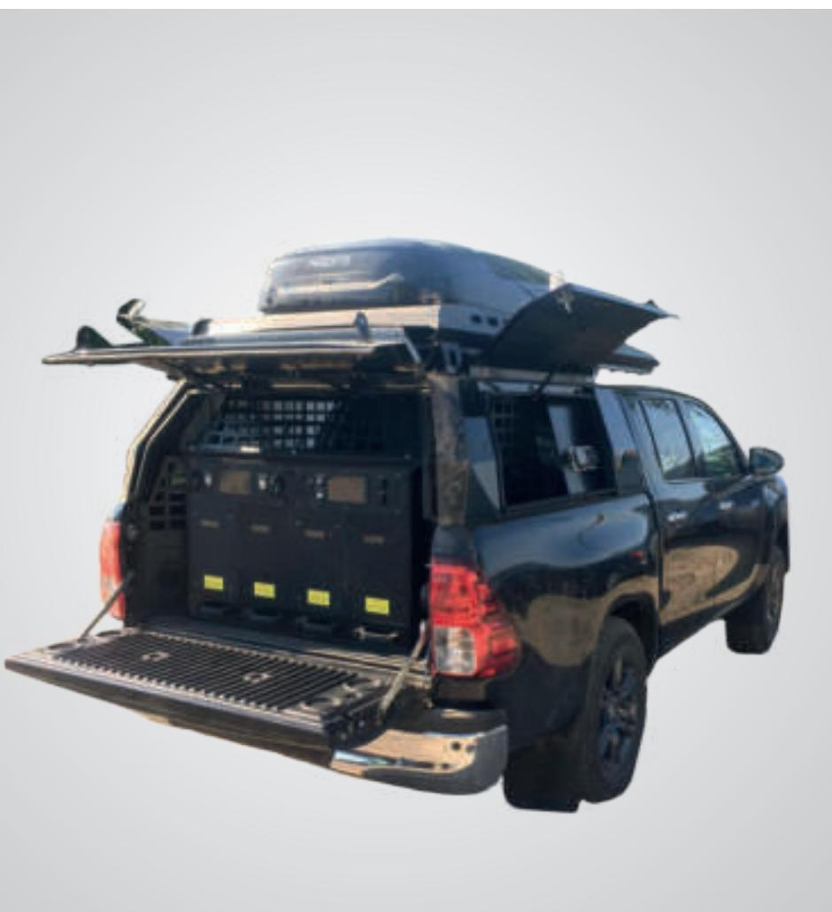
Изделие предназначено для обеспечения радиоэлектронного противодействия каналам управления в диапазоне частот от 20 до 7000 МГц (опционально до 13000 МГц) при движении в качестве машины сопровождения в колонне.
