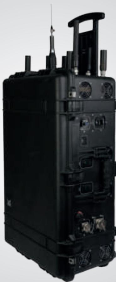
Блокиратор предназначен для противодействия радиоуправляемым взрывным устройствам (РВУ) посредством генерируемого сигнала во всем диапазоне рабочих частот, предназначен для защиты от РВУ при передвижении и в стационарном положении.
