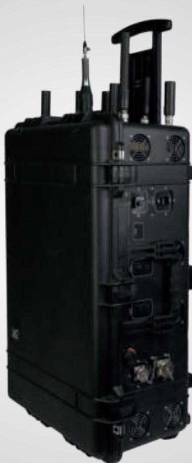
Изделие предназначено для противодействия радиоуправляемым взрывным устройствам (РВУ) посредством генерируемого сигнала во всем диапазоне рабочих частот при передвижении и в стационарном положении.
