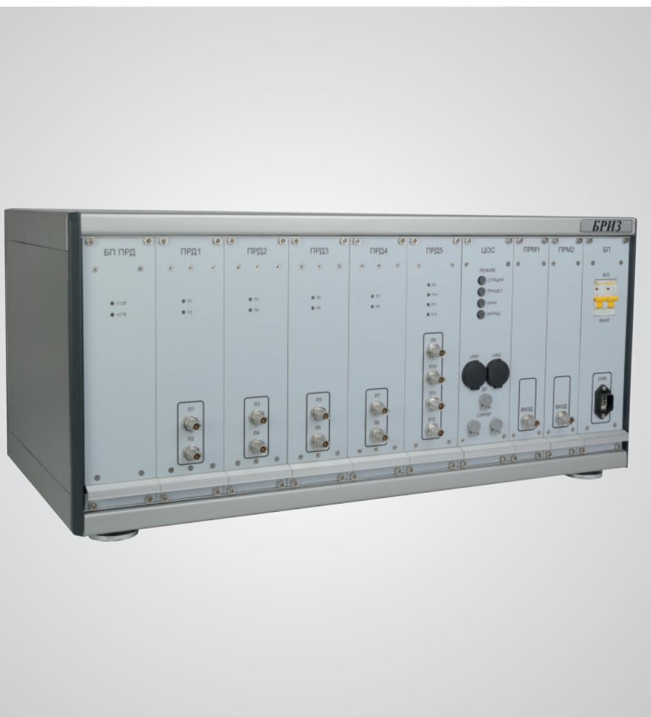
Комплекс предназначен для обнаружения, анализа и подавления радиолиний управления взрывными устройствами при одновременном сохранении возможности использования необходимого оборудования в рабочей зоне комплекса в диапазоне частот от 20 до 2750 МГц.
